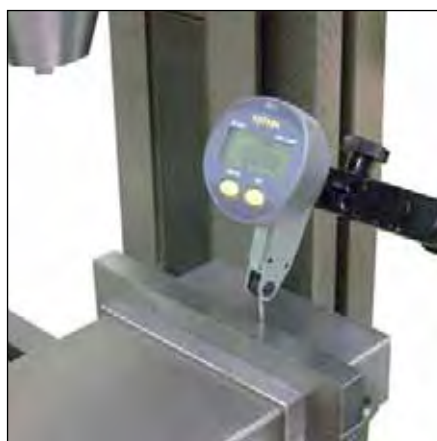
Vérification de l'alignement d'un étou de fraiseuse
