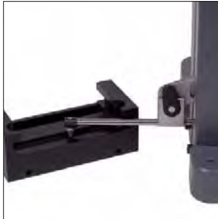
Mesure de profondeur avec accessoires 930.2108 et 905.2204
