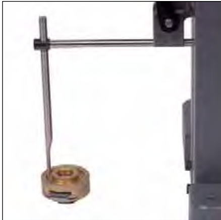
Mesure de profondeur avec accessoires 930.2108 et 930.2105
