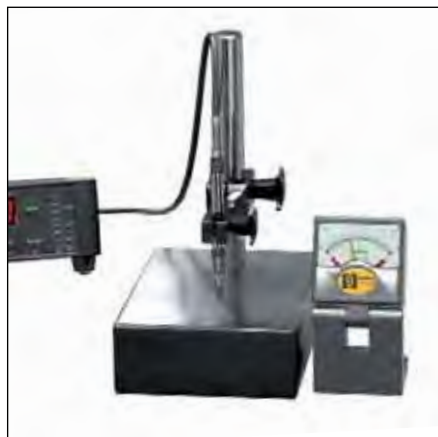
Poste de mesure avec plapeur P2B, unité D60S PRO et affichage analogique
