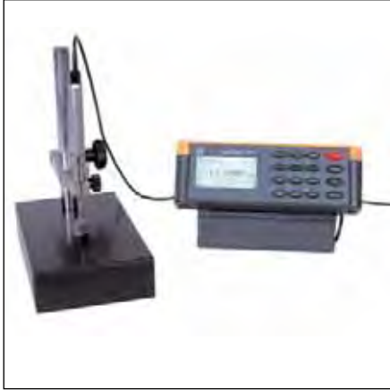
P25 connecté à une unité D80S mesurant la hauteur d'une pièce
