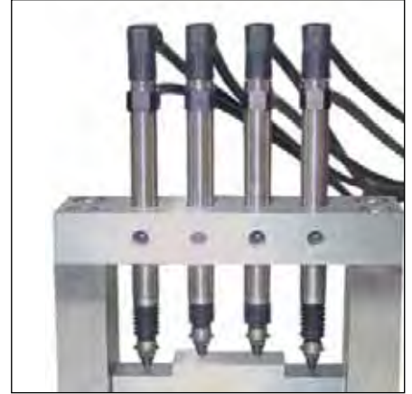
Combinaison de palpeur pour la mesure de différentes hauteurs
