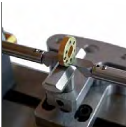
Touches couteaux épaisseur 0.4 mm et table XYZ standard
