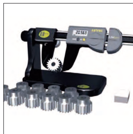
S_Cal Micron Mesures par comparaison avec câle-étalon
