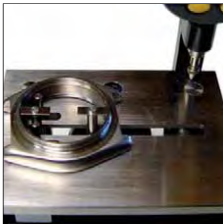
Mesure intérieure en 2 points avec auto-centrage de la pièce sur LVS 50
