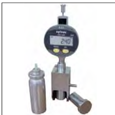
Contrôle de \varnothing intérieurs avec tête de mesure mécanique
