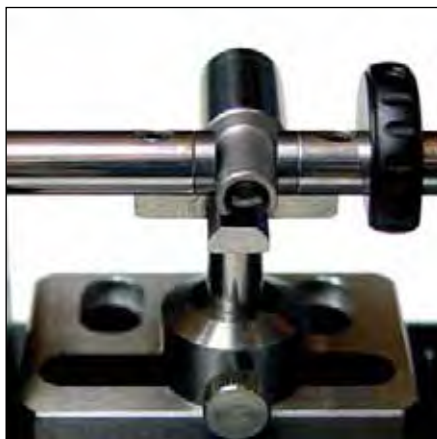
Mesure \varnothing extérieure avec touches \varnothing 6.5 et table XYZ
