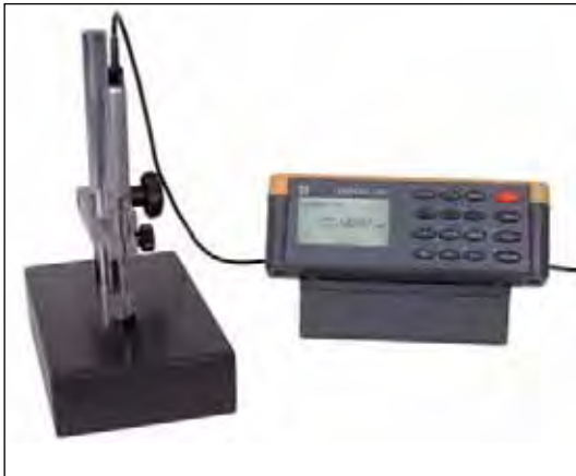
Mesure de 4 cotes, différentes sur 4 canaux avec un palpeur unique
