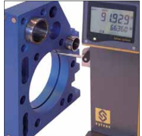
Mesure de diamètre intérieur avec touche bille rubis Ø 3 mm, 930.2101 livré en standard
